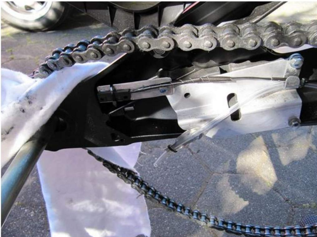
Die untere Halterung des Ölschlauches entstammt einem Set von Scottoiler und fand sich in meinem Teilefundus. Es ist aus Edelstahl und wurde an der Schleifmaschine etwas angepasst, der Schlauch wird daran am Ende mit zwei Kabelbindern gehalten (siehe unten).
