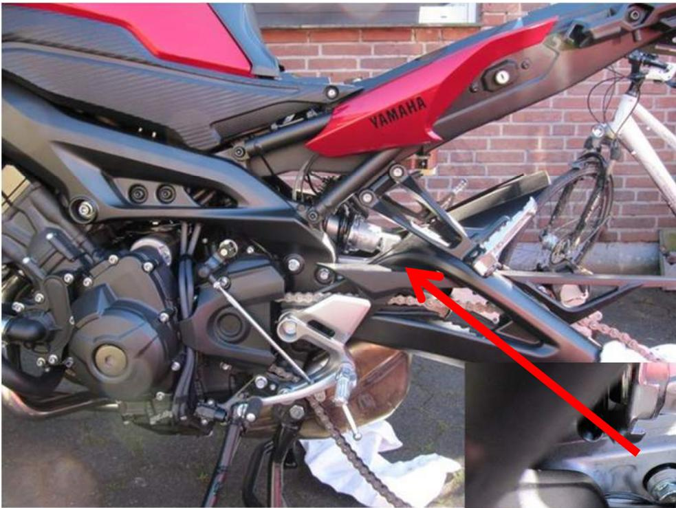
Der Schlauch tritt vorne an der Heckverkleidung aus und verläuft durchs Federbeinauge nach unten. Dort wird er an der Umlenkung des Federbeines befestigt.
