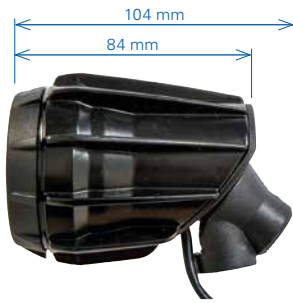
Scheinwerfereinsatz und Halter bestehen aus Kunststoff.
