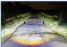
In der Praxis gut: Selbst aus 30 cm Höhe leuchtet Givi bis zum Ende der Messstrecke.
