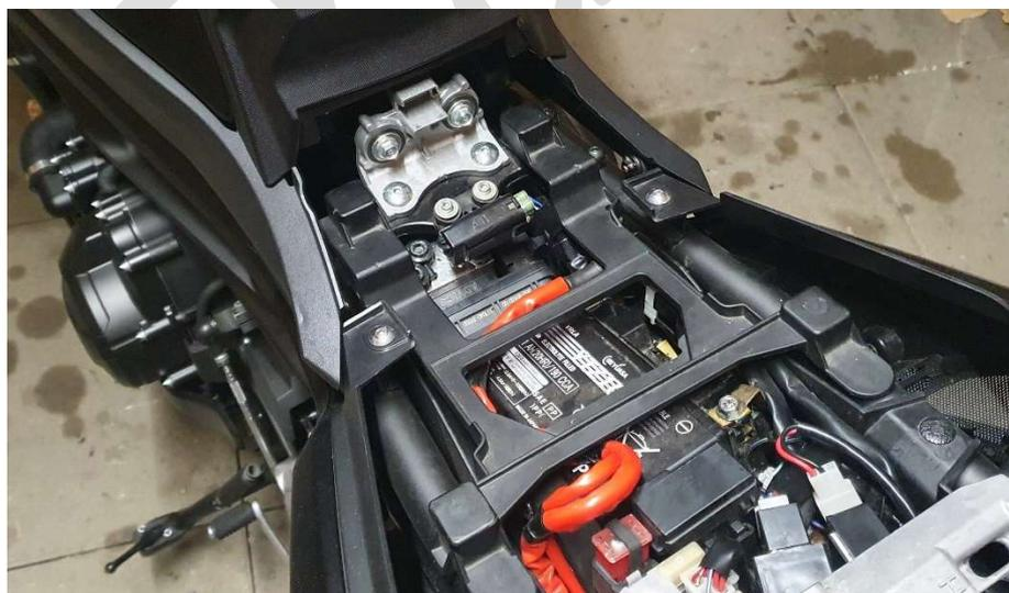
Danach entfernen wir den Rahmen für die Sitzverstellung und die mit rot markierten Schrauben und entnehmen den Querträger für die Tankbefestigung. Den Umkippsensor lassen wir an diesem sitzen und ziehen lediglich den Stecker ab.
