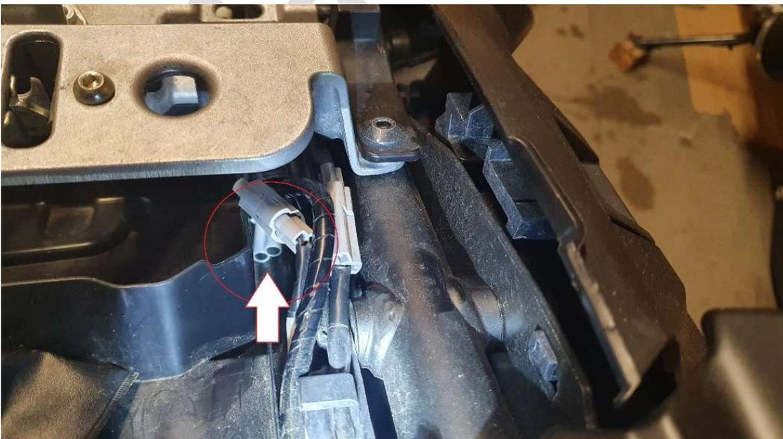
Diesen Anschluss holen wir uns hoch und verlegen ihn nach vorne rechts neben die Batterie, schneiden den Stecker ab (man könnte auch Pins in das leere Steckergehäuse geben, und den Speedohealer so verbinden, hatte leider keine da). Der Speedohealer wird später auf dem ABS platziert, also kürzen wir uns das Anschlusskabel entsprechend ein, mit ca 5 cm mehr als wirklich benötigt, um später an dem Speedohealer auch vernünftig arbeiten zu können.
