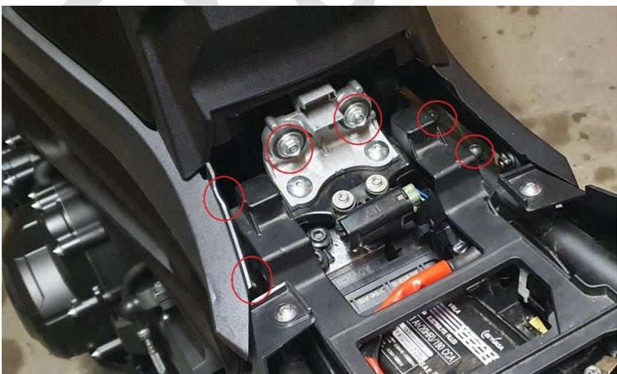
Wenn das alles geschehen ist, können wir den Stecker des ABS Steuergerätes endriegeln (in Fahrtrichtung rechts, Bügel des Steckers nach vorne drücken) abziehen und nach oben holen.
