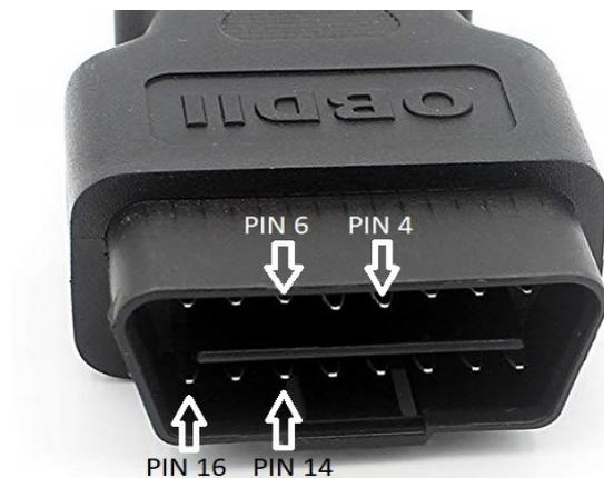
Diese 4 Kabel müssen nun wie folgt an der Buchse angeschlossen werden. Beim drehen des Steckers, bitte immer drauf achten das sich der Blickwinkel ändert.
